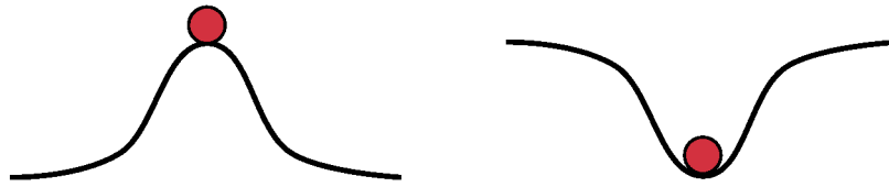
شکل ۱.۸ موقعیت‌های تعادلی مختلف یک توپ. شکل سمت راست (چپ)، یک موقعیت پایدار (ناپایدار) را برای توپ کروی شکل نشان می‌دهد. پایداری یا ناپایداری حالت توپ را با بررسی پاسخ توپ به اختلال‌های خارجی بی‌نهایت کوچک می‌توان فهمید.
